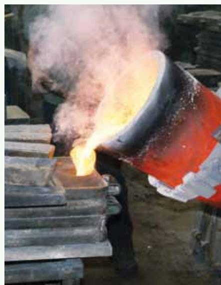
Bronze heran. Über der vorgefertigten Eingießöffnung wird die Glocke geneigt, so dass der 1250 Grad heiße Metallstrom zielgenau in die Öffnung fließt.
