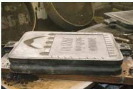
Sand gefüllt und mit einem Pressluftstamper verdichtet. 5 Löcher werden eingestanz, die beim Guss die 5 Befestigungszapfen ergeben. Beide Sandformen werden nun für den Guss vorbereitet: Eine Öffnung mit
